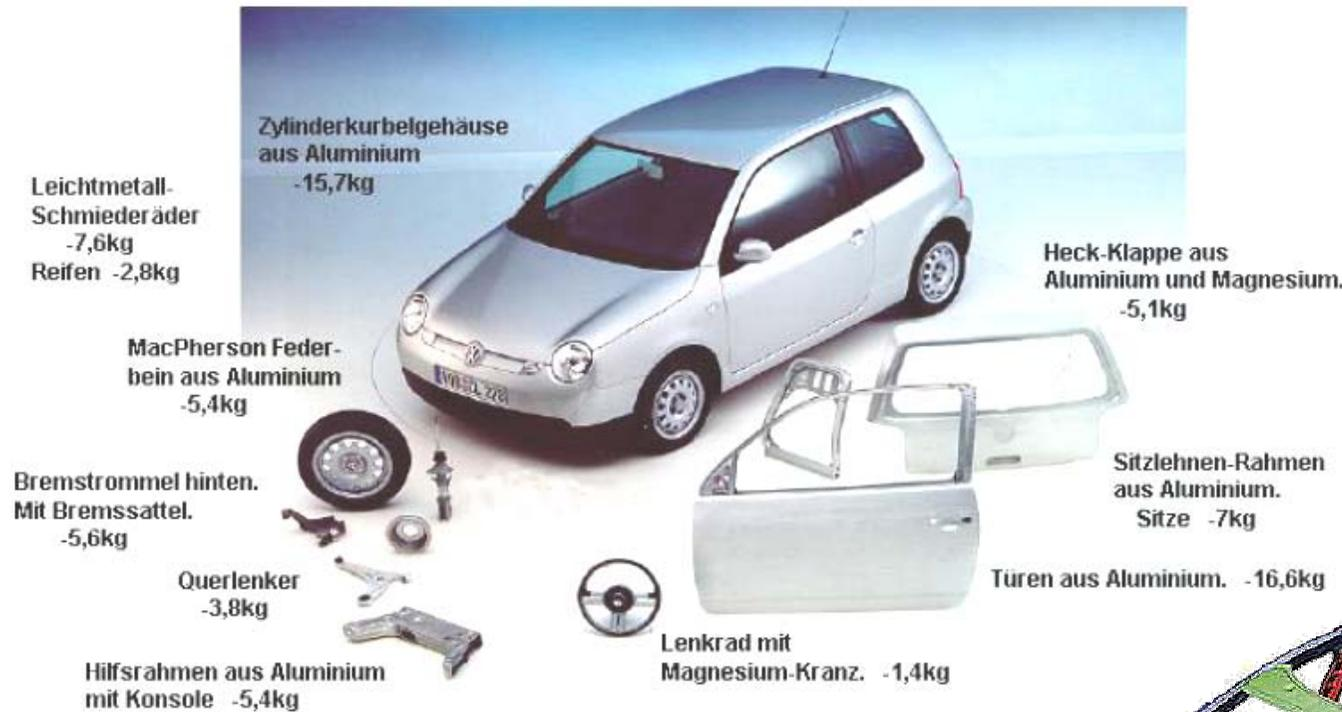
Als praktizierter Leichtbau mit Multi-Material-Bauweise gilt der Drei-Liter-Lupo von VW. Es ist das erste Serienfahrzeug dieser Verbrauchsklasse, bei dem durch die kombinierte Anwendung verschiedener Materialien Gewichtseinsparungen von 180 kg realisiert werden konnten.
