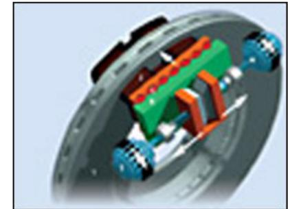
Bei der EWB hat jedes Rad seine eigene Kontrolleinheit. **Sie besteht aus dem Bremsklotz, einer mechanischen Übertragung, zwei Elektromotoren für die exakte Steuerung und einer Sensorik** zur Erfassung der auftretenden Bewegungen und Kräfte. Etwa 100-mal in der Sekunde messen vier Sensoren die Radumdrehung und damit die Geschwindigkeit des Fahrzeugs, die an der Bremse herrschenden Zuspännkräfte und die Position des Keils.
